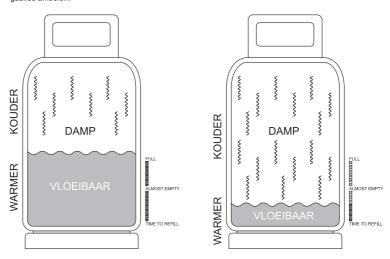
De Gasniveau-indicator is een zeer gevoelige thermometer die de temperatuurverandering veroorzaakt door verdamping meet aan de buitenkant van de gasfles. Dit temperatuurverschil zorgt ervoor dat één of meer kolommen van kleur zullen veranderen, precies op de plek waar de buitenkant van de gasfles van temperatuur verandert. De verticale indicatie is dus het belangrijkst, het gasniveau ligt waar de meeste cellen van kleur veranderen. De horizontale indicatie meet de omgevingstemperatuur.
