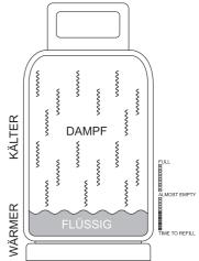
Der Gas Level Indicator ist ein hochempfindliches Thermometer, das die Temperaturänderung durch Verdunstung an der Außenseite der Gasflasche misst. Dieser Temperaturunterschied sorgt dafür, dass eine oder mehrere Säulen ihre Farbe genau dort ändern, wo die Außenseite der Gasflasche die Temperatur ändert. Die vertikale Anzeige ist daher am wichtigsten, der Gasfüllstand ist dort, wo die meisten Zellen ihre Farbe ändern. Das horizontale Display misst die Umgebungstemperatur.
